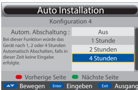
Bild 26 Erstinstallation - automatische Abschaltung einstellen
